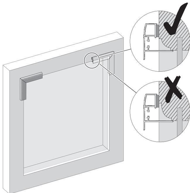
Contrôlez à l'aide du coin de mesure si la fenêtre convient à l'Easy fit. Placez le coin de mesure dans un coin de la fenêtre et vérifiez que toute la largeur de la bande magnétique touche le cadre de fenêtre, comme indiqué dans les dessins à gauche.
