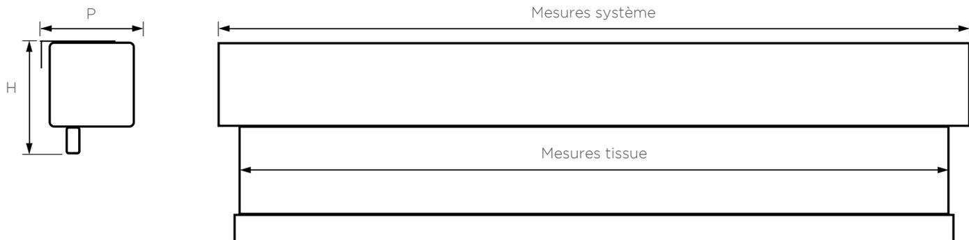
Profondeur d'encastrement, support et commande inclus (P)
