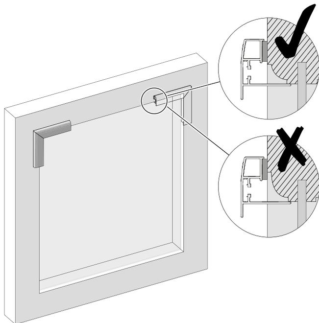
Contrôlez à l'aide du coin de mesure si la fenêtre convient à l'Easy fit. Placez le coin de mesure dans un coin de la fenêtre et vérifiez que toute la largeur de la bande magnétique touche le cadre de fenêtre, comme indiqué dans les dessins ci-dessous.
