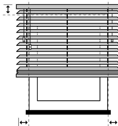
1. Mesurez la largeur en mm y compris le recouvrement souhaité du châssis.
