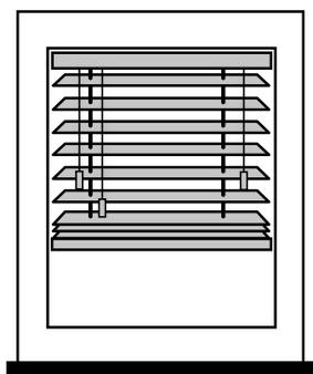
1. Mesurez la largeur en mm entre le châssis de fenêtre ou le mur à trois différents endroits. En cas de différences, notez toujours la largeur la plus petite.
