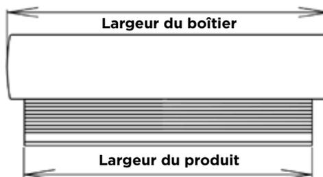
**Placement dans le châssis :** largeur boîtier = largeur produit + 1 cm
