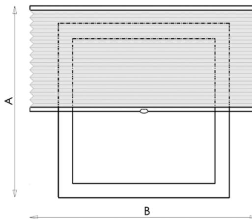
1. Mesurez la largeur (B) recouvrement souhaité compris.
